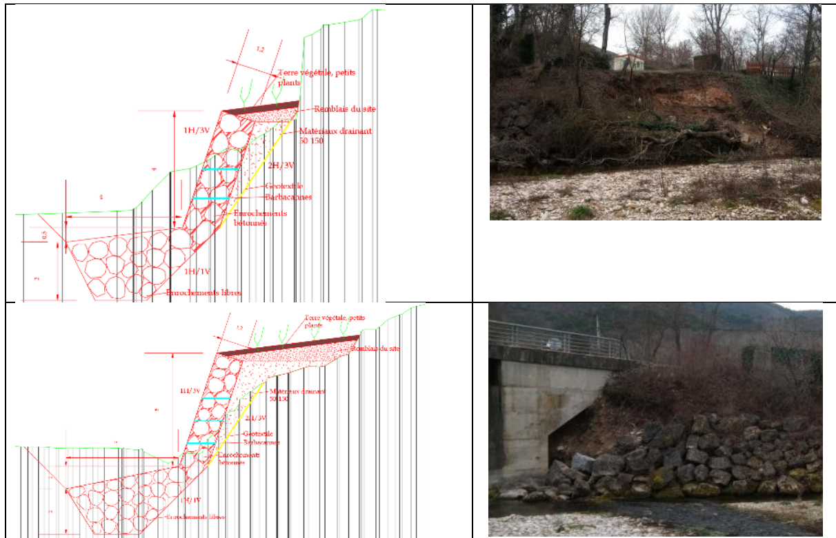
Figure 112 : Coupe type du confortement à l'amont (dessus) et à l'aval (dessous).
